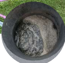
Reactor 2 MBRR. Reactor para Nitrificación
